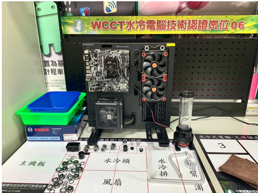
(圖一 弘光科技大學水冷式電腦技術設備)
