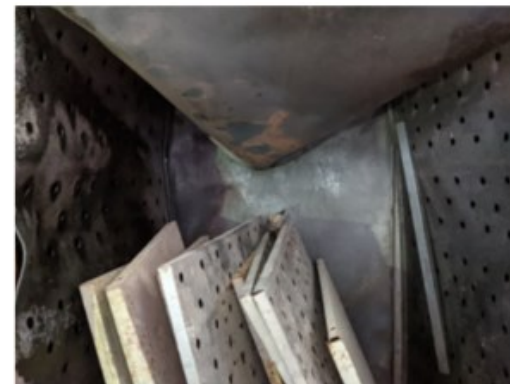
此圖為左方照片之放大，中央鐵板向下凸出，顯然爆炸點係於鐵板上方之電路配電空間。
