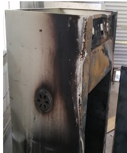
此圖為左方照片之放大，中央鐵板向下凸出，顯然爆炸點係於鐵板上方之電路配電空間。
