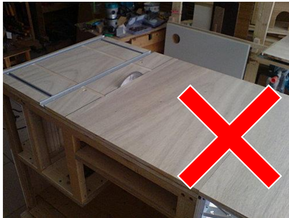
自製鋸台(安全性不合法規規定)
