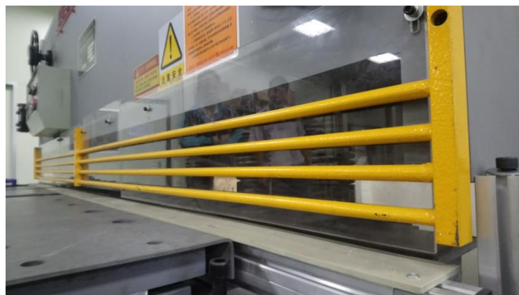
安全護圍裝置
