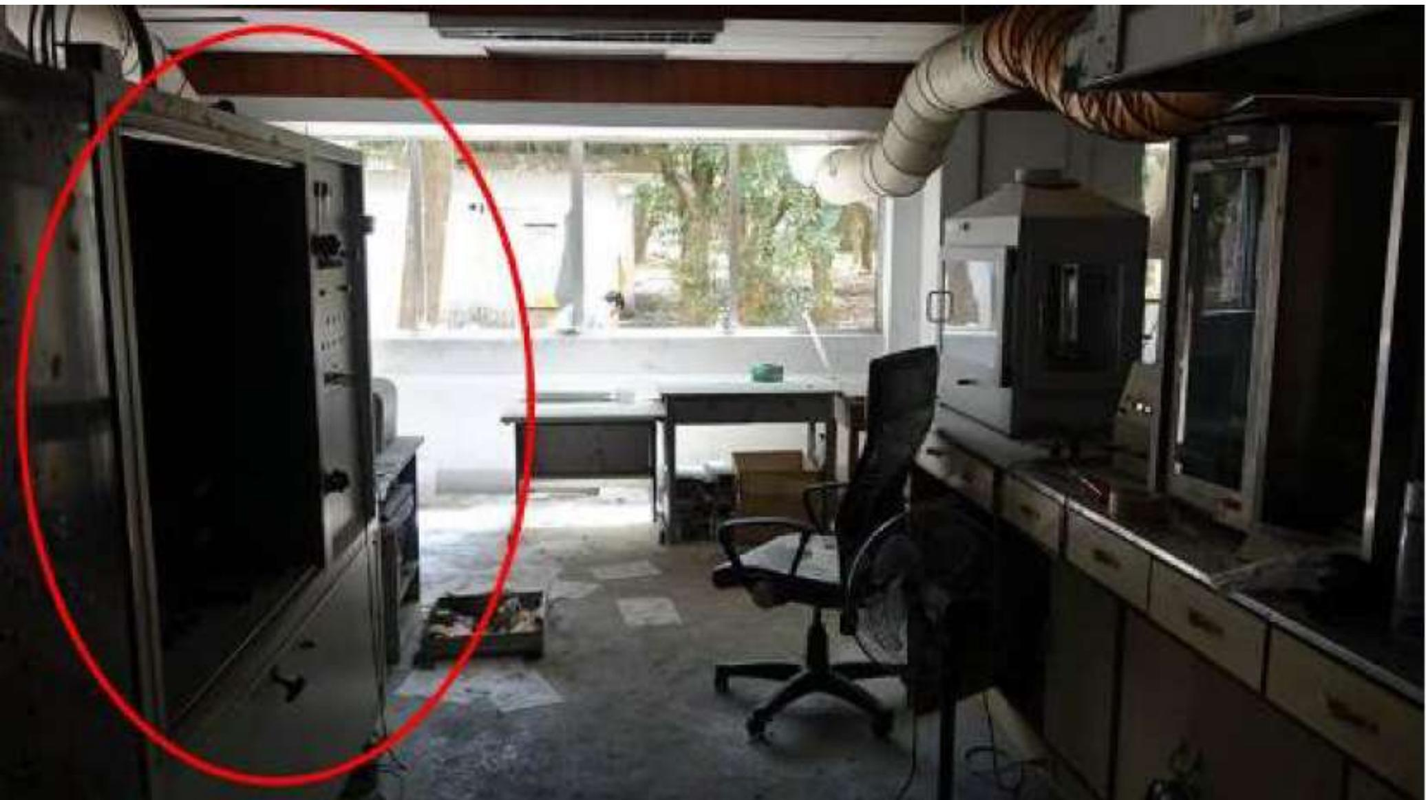
防火材料煙濃度試驗機設備外觀
