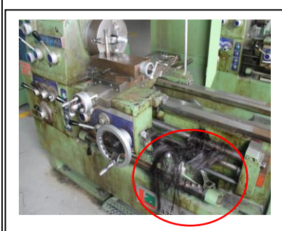
操作車床人員未確實著用適當的帽子致頭髮遭導桿捲入
