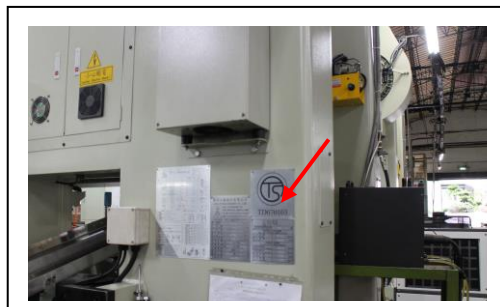
附照 2：衝剪機械產製運出廠場或輸入者,是否於勞動部職業安全衛生署機械備器具安全資訊網指定申報登錄網站完成登錄及張貼安全標示。
