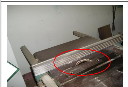
木材加工用圓盤鋸未設置護罩或護圍等設備
