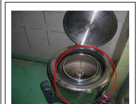
脫水機(離心機械)應依規定設置連鎖裝置
