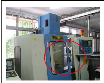
CNC銑床未具有連鎖性能之安全門
