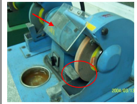
桌上用研磨機或床式研磨機，應設有舌板可調整研磨輪與工作物支架之間隙在3毫米以下之工作物支架
