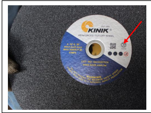
附照 3：研磨輪張貼安全標示。
